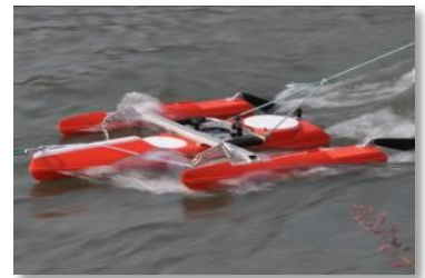
水中部は、ADCP 等で補足計測
